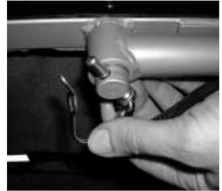
Stecken Sie den kürzeren Federclipbolzen durch die Bohrung im Deichselzapfen und sichern diese durch Verriegeln des Federclips.
