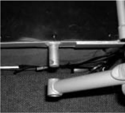
Führen Sie das Anschlussstück der Deichsel über den Deichselzapfen an der linken Rahmenseite.
