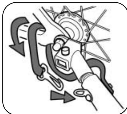
Sichern Sie die Deichsel, indem Sie das Sicherungsband um den Hinterbau des Fahrradrahmens legen und mit dem Karabinerhaken am Deichselring befestigen.
