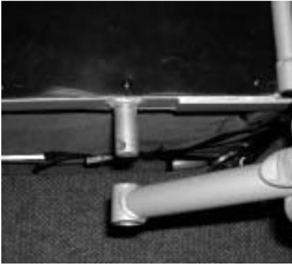
Duw het aansluitelement van de dissel over de disselpen aan de linkerzijde van het frame.
