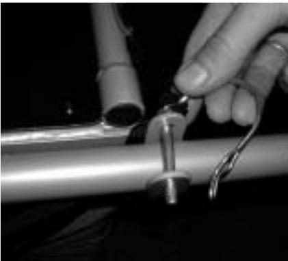
Stecken Sie den längeren Federclipbolzen durch die Bohrung in der U-förmigen Aufnahme und sichern diesen durch Verriegeln des Federclips.
