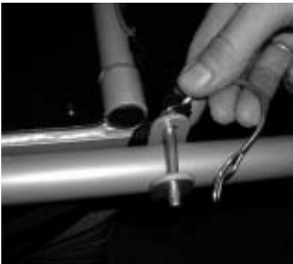
Steek de langere veerklemmen door het gat van het U-vormige aansluitelement en maak hem vast door de veerklem te sluiten.
