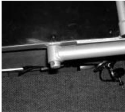
Leg de dissel in het U-vormige aansluitelement.
