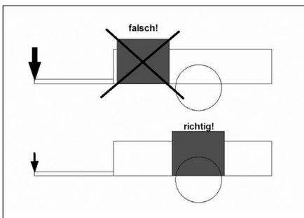
Für das Fahrverhalten eines Fahrrades mit Anhänger spielt die Gewichtsverteilung der Ladung eine grosse Rolle. Zuviel Gewicht vor den Laufradachsen des Hängers erhöht die Stützlast an der Kupplung. Das wirkt sich negativ auf das Fahrverhalten des Fahrrades aus. Achten Sie beim Beladen des Anhängers daher darauf, schwere Gegenstände im Ladenflächenbereich über den Achsen zu verstauen.
