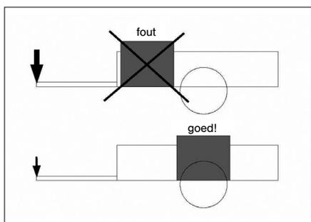
De gewichtsverdeling van de lading is erg belangrijk voor het rijgedrag van een fiets met aanhanger. Teveel gewicht vóór de aanhangerwielen verhoogt de belasting op het koppelingselement. Dat heeft een negatief effect op het rijgedrag van de fiets. Let bij het inladen van de aanhanger er goed op dat zware voorwerpen boven de assen worden geplaatst.
