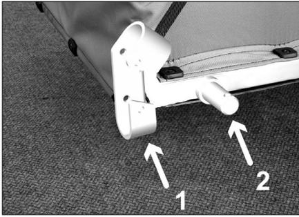
Het ontvangende element voor de dissel van de Cargo Croozer stelt u in staat de dissel in twee standen te bevestigen: in de onderste stand bij gebruik als fietskar of in de bovenste bij gebruik als handkar.
