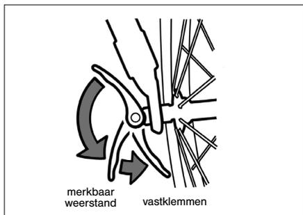
Om er voor te zorgen dat de naaf met voldoende spankracht in het aselement vastzit, moet de snelspannerhendel halverwege het sluitproces weerstand beginnen te voelen, en moet op het laatst met duidelijke kracht dichtgedrukt worden. Als de snelspanner te moeilijk of te makkelijk sluit, moet de basisinstallatie met de tegenmoer aan de andere naafzijde gecorrigeerd worden door deze losser of vaster te draaien.
