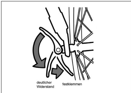
Damit die Nabe mit ausreichender Spannkraft in der Achsaufnahme klemmt, muss der Schnellspannhebel auf seinem Weg von der geöffneten bis zur Mittelstellung zu greifen beginnen und bis zur geschlossenen Stellung gegen spürbaren Widerstand gedrückt werden. Lässt sich der Schnellspanner zu schwer oder zu leicht betätigen, wird die Grundeinstellung mit der Gegenmutter an der anderen Nabenseite durch Auf- bzw. Zudrehen korrigiert.
