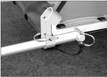
Voor gebruik als fietskar, wordt de dissel in de laagste stand in de disselschaar gestoken. Steek de langere veerklampen door beide onderste gaten van de disselschaar en maak hem vast door de beugel te sluiten. De veerklambeugel moet helemaal om de bout heen liggen.
