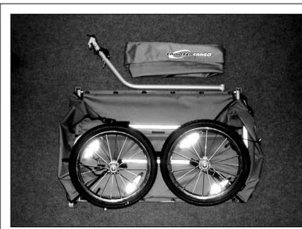
Rahmen mit Seitenteilen, 2 Laufräder, Deichsel mit Kupplung, Verdeck
