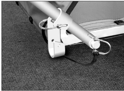
Für den Einsatz als Handwagen rasten Sie die Deichsel in der oberen Position in der Deichselkulissee ein. Stecken Sie den längeren Federclipbolzen durch die beiden oberen Bohrungen der Deichselkulissee und sichern Sie ihn durch Umlegen des Federclipbügels. Der Federclipbügel muß den Bolzen nach dem Schliessen umfassen. Der Wechsel von unterer zu oberer Position kann ohne Abnehmen der Deichsel vorgenommen werden.
