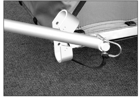
Schieben Sie die Deichsel soweit wie möglich auf den Deichselzapfen auf. Stecken Sie den kürzeren Federclipbolzen durch die Bohrung im Deichselzapfen und sichern Sie ihn durch Umlegen des Federclipbügels. Der Federclipbügel muß den Bolzen nach dem Schliessen umfassen.
