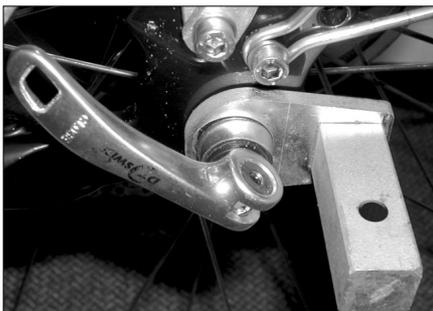
Schnellspanner demontieren und mit der Schnellspannachse durch das Kupplungsstück führen. Schnellspanner wieder durch die Hohlachse schieben, die Mutter montieren und Schnellspanner mit richtiger Vorspannung klemmen. Das Kupplungsstück dabei waagrecht ausrichten und den Schnellspannhebel so ausrichten, daß der Vierkantdeichselanschluß darüber passt. (siehe auch 1. Bild in Kapitel 2.1.2.)
