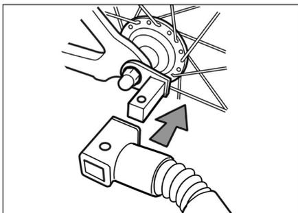
Schieben Sie den Vierkantdeichselanschluss über das ans Fahrrad montierte Kupplungsstück.
