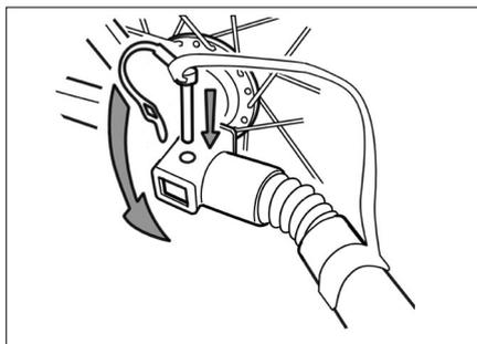
Steek de veerklemmen door de boorgaten van beide koppelingsonderdelen en sluit de beugel, zodat de opening van de klem over het uiteinde van de pen ligt.
