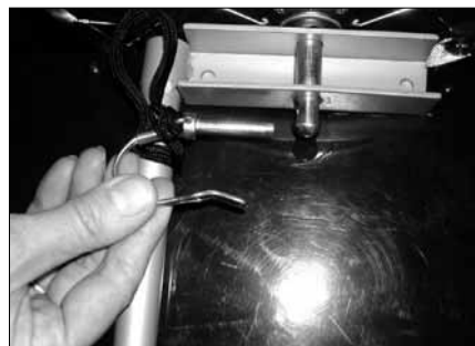
Schieben Sie den Federclipbolzen durch die Bohrung der Achse.
