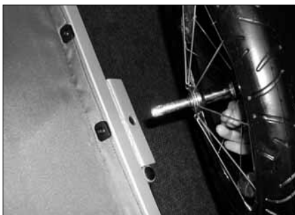
Führen Sie die Achse in die Aufnahme am Vierkantrahmen ein.
