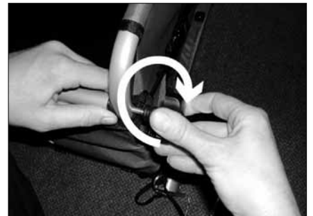
Beide Querrohre mit den an Bändchen befestigten Sterngriffbolzen festschrauben.
