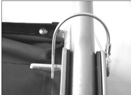
Endzustand des Sicherungsstiftes
