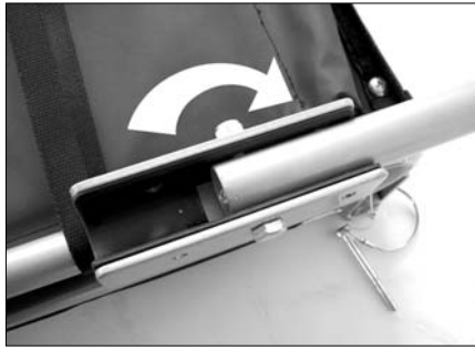
Deichsel in die andere Position klappen,
