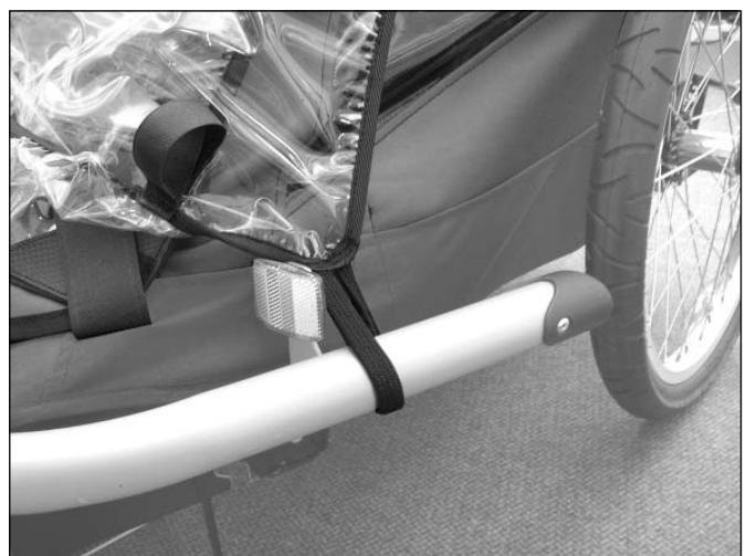
**7. Schritt:** Ziehen Sie die mittlere elastische Schlaufe über die Halterung für das Buggy-Rad.
