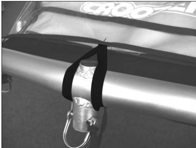
**8. Schritt:** Befestigen Sie das Regenverdeck auf beiden Seiten mit den Klettböndern an der Stoßstange.
