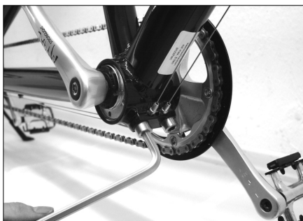
Lösen der Exzenterklemmschrauben
