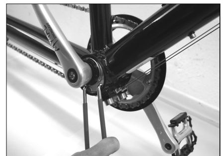
Drehen des Exzenters zur Spannung der Übertragungskette
