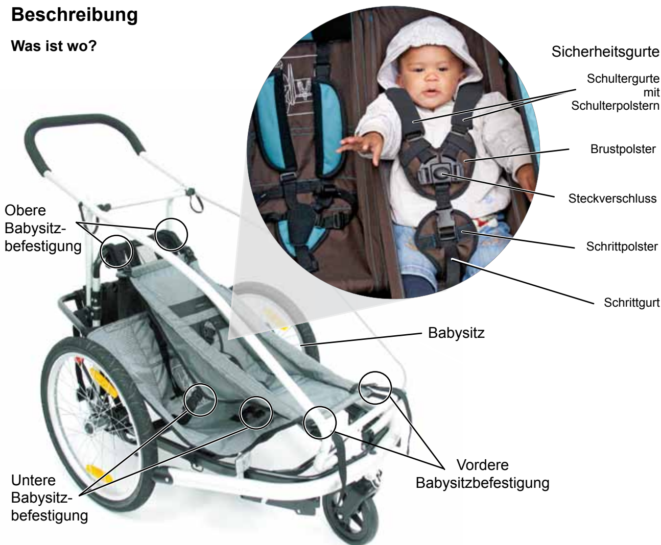
Schematische Darstellung Croozer Kid for 1 mit eingebautem Babysitz
